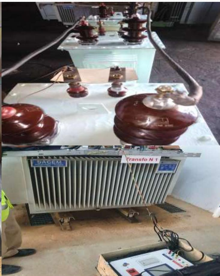
Tous les transformateurs sont soumis à des essais de routine conformément à la norme CEI 60076. Ces essais sont :
